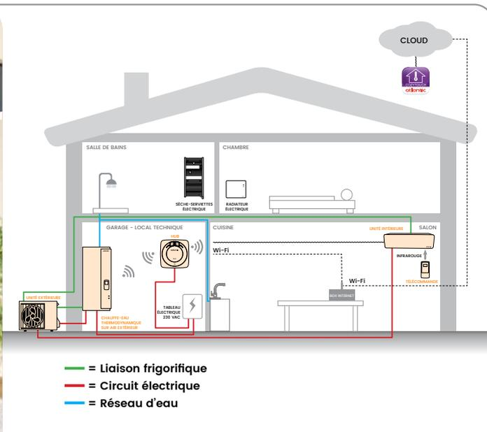
Solution 3 services avec chauffage, climatisation et eau chaude sanitaire
